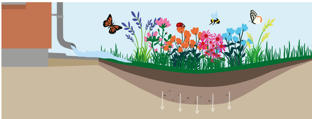
Opbygning af et regnbed. Bland sand eller grus i det nederste lag jord, så vandet nemmere kan sive væk.
